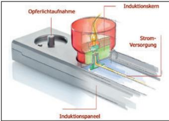
Der LED Opferlicht funktioniert mit 220 Volt aus der Steckdose. Die **Stromversorgung** für die extrem sparsamen LED-Kerzen ist, für maximale Sicherheit, schützend im Gehäuse verbaut. Ein **Induktionspaneel** versorgt das Opferlicht über den **Induktionskern** mit Energie. Die LED Kerze wird einfach auf die **Opferlichtaufnahme** gestellt und das Licht flackert ohne Flamme. Die Leuchtdauer kann zwischen 3, 6 oder 9 Stunden eingestellt werden.
